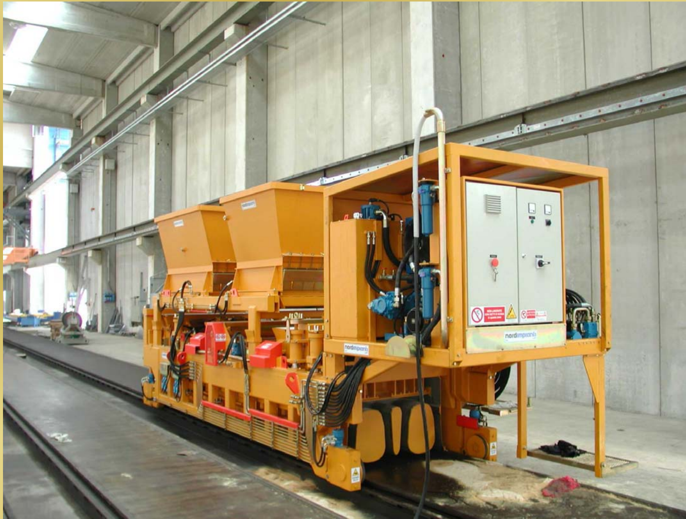
Macchina vibrofinitrice per grandi alveolari Vibrofinishing machine for deep hollow core
